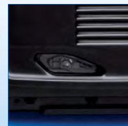
Contrôle aisé du niveau d'huile avant le démarrage
